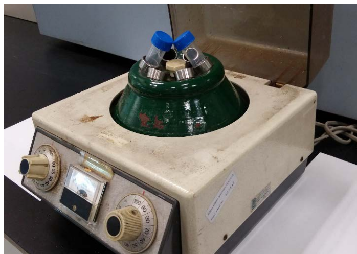
圖 3. 離心管應水平設置在離心機裡，確保質量相同
