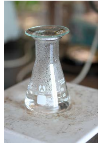
圖 2：合成 13 nm 金納米粒子的裝置
