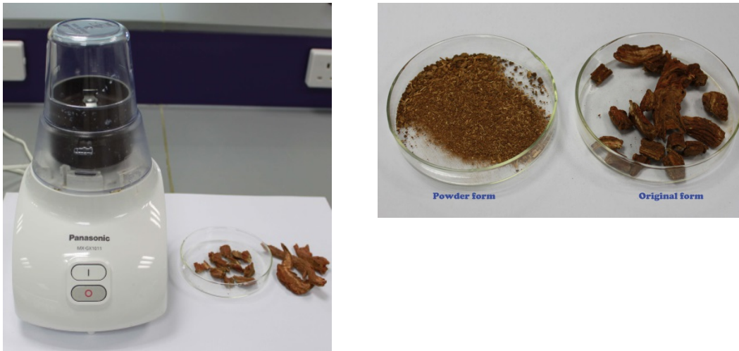
圖二 使用攪拌機砸碎固體樣品為粉末狀
